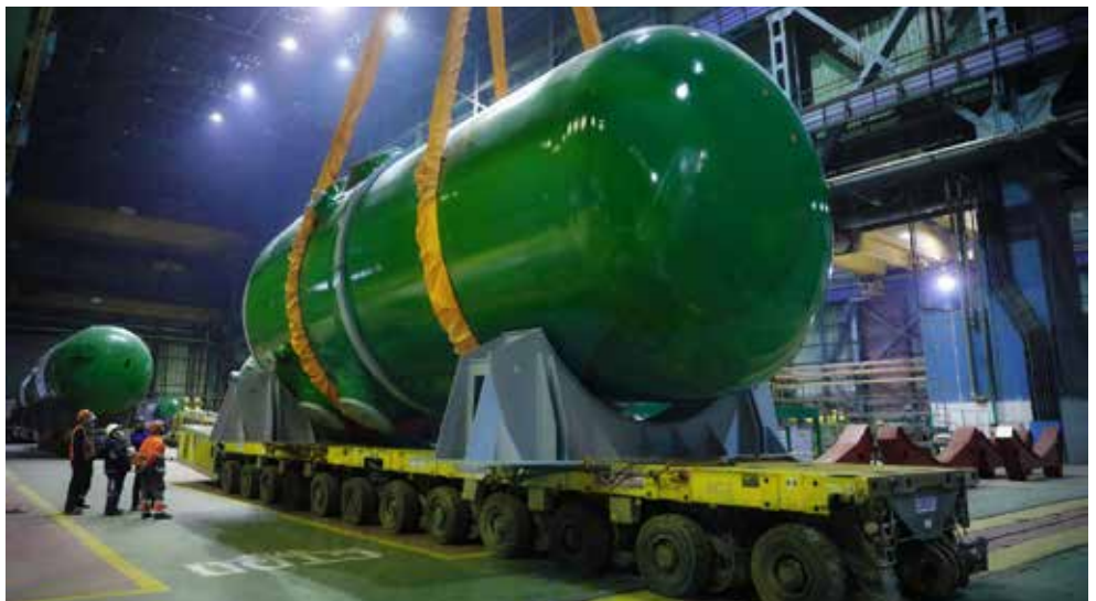
A Ruppuri Atomerőmű második blokkja számára elkészült VVER-1200 típusú reaktortartály
