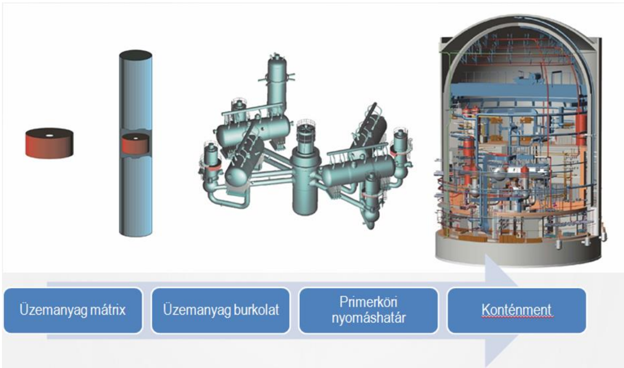
3.4.1-1. ábra: Mérnöki gátak atomerőművi blokkoknál [3-6]
